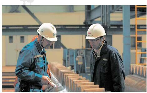
德国劳氏船级社高级验船师正在检验即将出口阿联酋的钻井平台桩腿齿条
